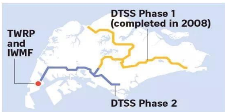
新加坡深层隧道污水处理系统 ——新加坡投资规模最大的水利工程
