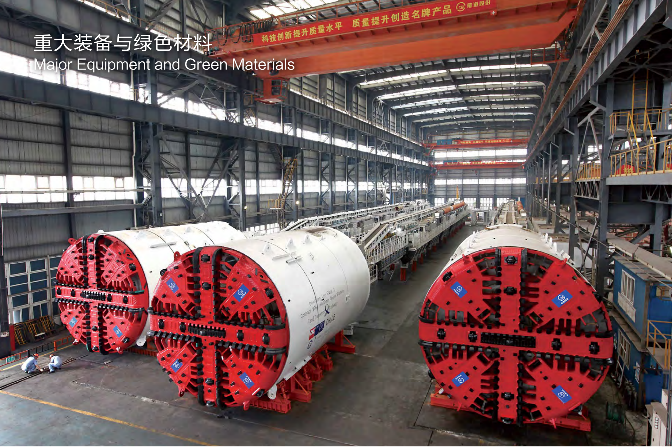
具有完全自主知识产权的新加坡地铁定制的直径6.67米铰链式土压平衡复合盾构
