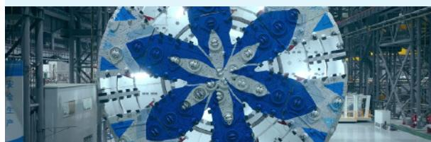
在国家“863计划”支持下，隧道股份先后研制出具有完全自主知识产权的中国国产盾构——直径6.34米的“先行号”土压平衡盾构，并在此基础上自主研发11.22米大直径泥水平衡盾构“进越号”，合作研制14.27米、15.43米等超大直径盾构机。目前，隧道股份已累计研发制造近200台国产盾构，设备成功销往新加坡、印度、香港等地。
