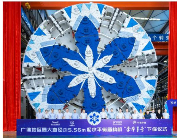
隧道股份上海隧道自主研制的国产超大直径盾构“骐跃号”风帆正满，击楫奋进。将从华泾站始发并向三林南站掘进，完成 4281 米的区间掘进任务。隧道掘进将面临长距离掘进、超深覆土施工、穿越众多重要建（构）筑物等难点。
